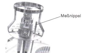
Zusammenbau in umgekehrter Reihenfolge. Dabei bei GG55 auf Position des Meßnippels achten (kleine Bohrung in der Stauscheibe, Kennzeichnung "M").
